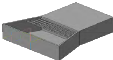
Рис. 3. Схема расположения натянутой страховочно-улавливающей сетки в оркестровой яме
