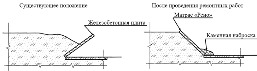
Рис. 1. Ремонт концевой части гасителя водосброса
